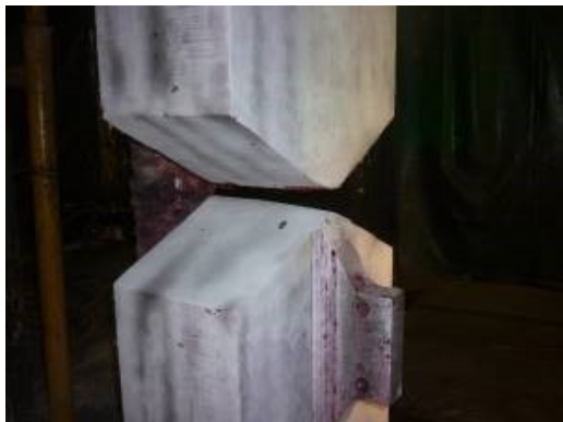
Coluna de Prensa fraturada e goivada
